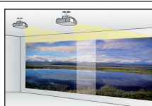
Sans la technologie de fusion des bords (Edge Blending).
