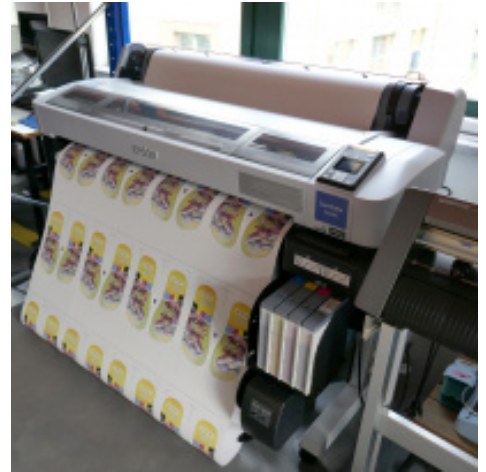
Der neue Transfer- Thermosublimationsdrucker Epson SC- F6000 bei palupas installiert.
