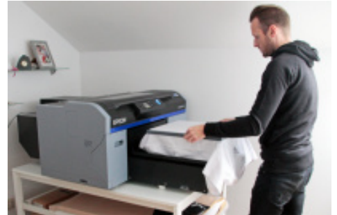
Mittels Rahmen fixiert Philipp Pfingstl das Textil auf der Standardplatte.
