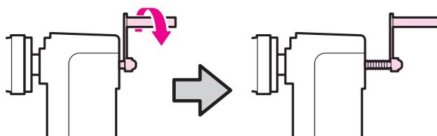
Si l'axe (pas de vis) de la manivelle du support de droite n'est pas visible, faites tourner sans forcer la manivelle dans le sens anti-horaire jusqu'à l'arrêt de celle-ci.
