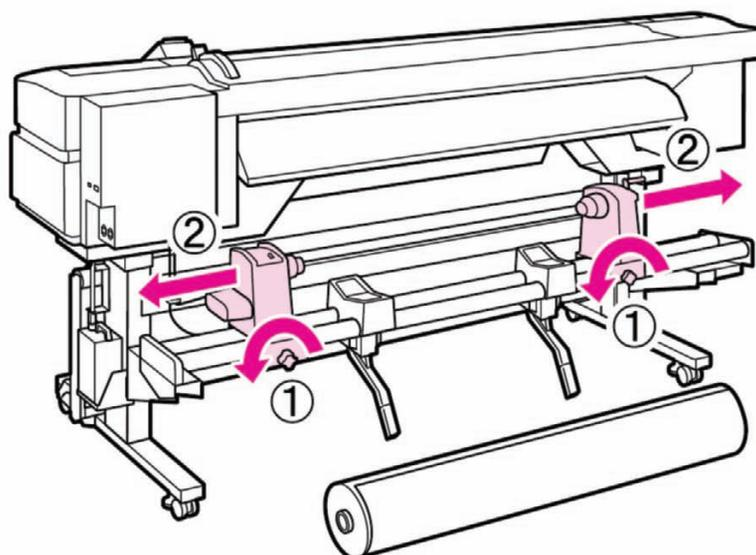
Desserrez les vis de fixation du support de rouleaux (1) et écartez les supports (2) pour pouvoir placer le média sur les crics de levage. Pour faciliter le chargement du rouleau, déplacez les supports à équidistance du centre.
