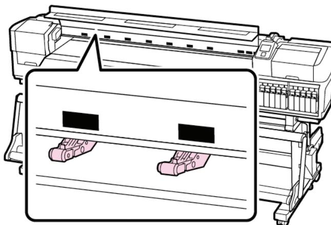
Lorsque les rouleaux presseurs sont correctement positionnés, abaissez le levier de prise papier pour maintenir le média en place. Toutes les imprimantes de la série SureColor S permettent le chargement par l'arrière des médias. Cette fonctionnalité a trois grands avantages.
