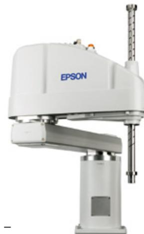
Die Epson SCARA G20 sind für sehr hohe Traglasten mit einem Gewicht von bis zu 20 kg geeignet. Mit einer Armlänge von 1.000 bzw. 850 mm wird ein großer Arbeitsbereich abgedeckt. Durch das hohe Trägheitsmoment der U-Achse können schwere Lasten schnell und zuverlässig bewegt werden – ohne Schwingungen des Roboterarmes, wie bei vielen Wettbewerbsmodellen mit ähnlicher Armlänge
