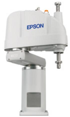
Durch das besondere Design können die SCARA G6 Aufgaben mit einer Armlänge von beispielsweise 550 mm erledigen, für die man üblicherweise 600 mm braucht. Die G6 sind ideal geeignet für Anwendungen, bei denen es auf hohe Geschwindigkeit bei maximaler Präzision ankommt – zum Beispiel in der Fertigung mechanischer und elektrischer Bauteile, bei Pick-and-Place-Applikationen, Bestückungen im Kleinteilebereich, Dosieren und Zuführen.
