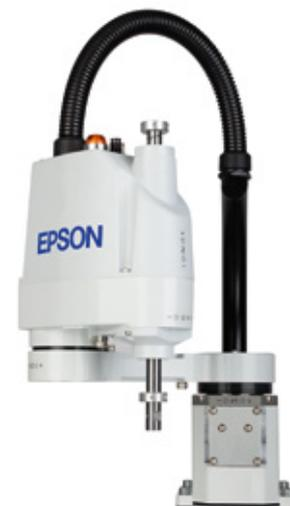
Die SCARA G3 decken bei kompakter Größe einen großen Arbeitsbereich ab. Da viele Montagearbeiten nur in einer Armorientierung bewältigt werden, haben wir die Epson G3-Serie auch mit einem nach links bzw. rechts geknickten ersten Arm entwickelt. Durch diese spezielle Armgeometrie kann die max. quadratische Arbeitsfläche um bis zu 40 % gesteigert werden.
