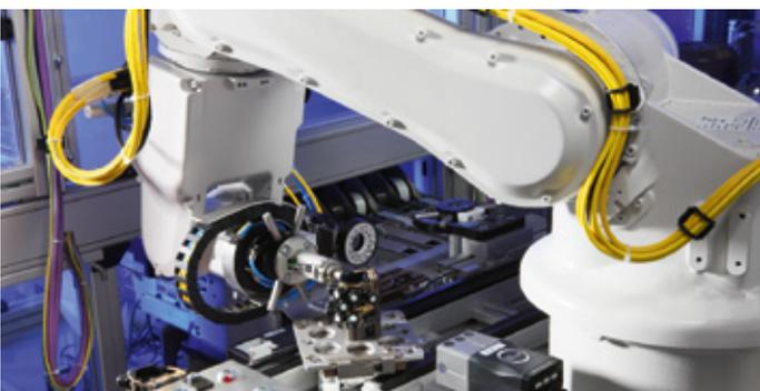
El montaje mecatrónico con tecnología MID (soportes de circuitos moldeados por inyección) tridimensional se puede ajustar, probar y ensamblar con los robots de Epson equipados con una cámara móvil.
