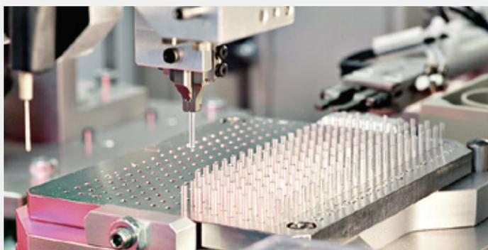
Una segunda cámara realiza inspecciones de calidad para verificar si las gotas dispensadas cuentan con la posición y el tamaño correctos.
