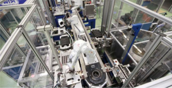
Gracias a su capacidad intrínseca de sujeción y movimiento flexible, el robot Epson de 6 ejes con funcionalidades de procesamiento de imágenes puede detectar la ubicación exacta de la pieza y realizar una verificación interior del contorno (ambas operaciones se pueden controlar fácilmente a través de una plataforma de software).
