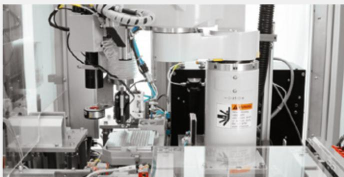
El robot SCARA de Epson para la esterilización de salas tiene una cámara móvil integrada que inspecciona diferentes áreas y permite realizar correcciones de precisión. Incluso cuando la pieza objetivo no está en la misma ubicación, su capacidad de guiar la cámara permite realizar dosificaciones precisas y adoptar las posiciones de sujeción adecuadas.
