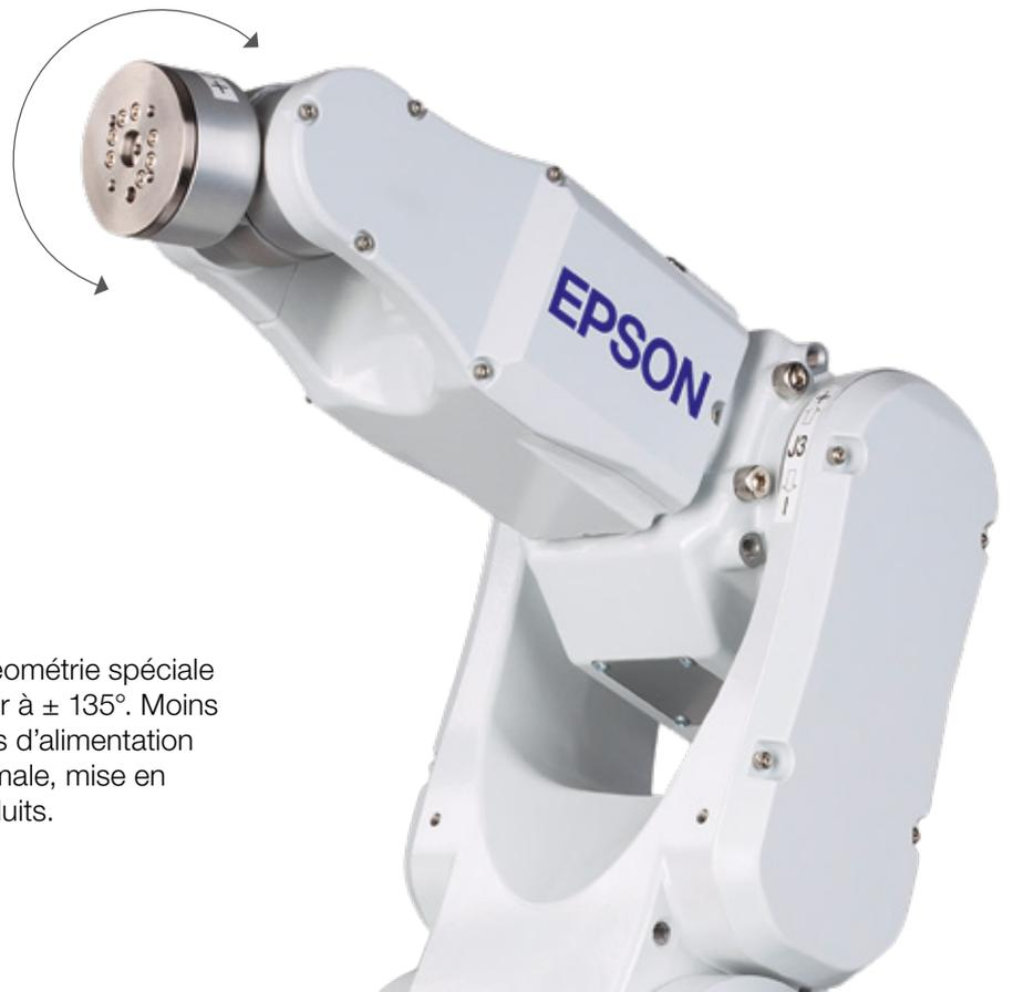
Liberté de mouvement accrue grâce à la géométrie spéciale des jointures, qui permet à l'axe 5 de pivoter à  $\pm 135^\circ$ . Moins d'interférences de contour, design fin, lignes d'alimentation internes pour une fiabilité de système maximale, mise en service simple et coûts de maintenance réduits.
