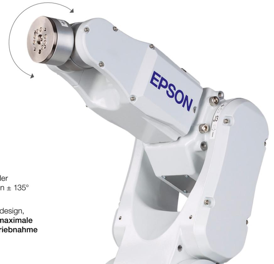
**Höhere Bewegungsfreiheit** dank spezieller Gelenkgeometrie, die einen Drehwinkel von  $\pm 135^\circ$  der Achse 5 erlaubt.
