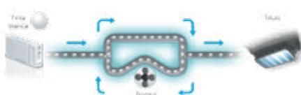
La bomba hace circular la tinta blanca para evitar que se atasque el cabezal de impresión
