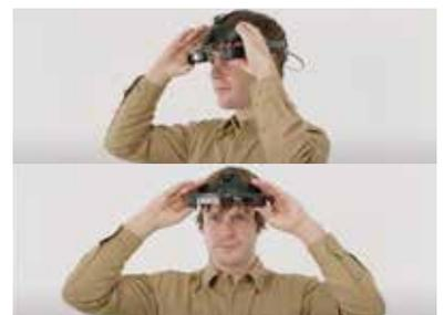
Zum Hochklappen halten Sie das Stirnband und drücken Sie das Display nach vorne
