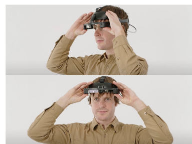
Pour relever le dispositif, maintenez le serre-tête et poussez l'écran vers l'avant
