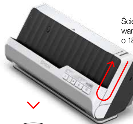
Przesunięcie przycisku selektora w poprzek powoduje regulację kąta skanera
