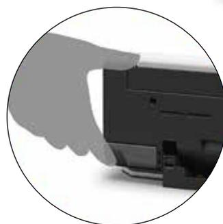
El ángulo del escáner se ajusta deslizando el selector de posición
