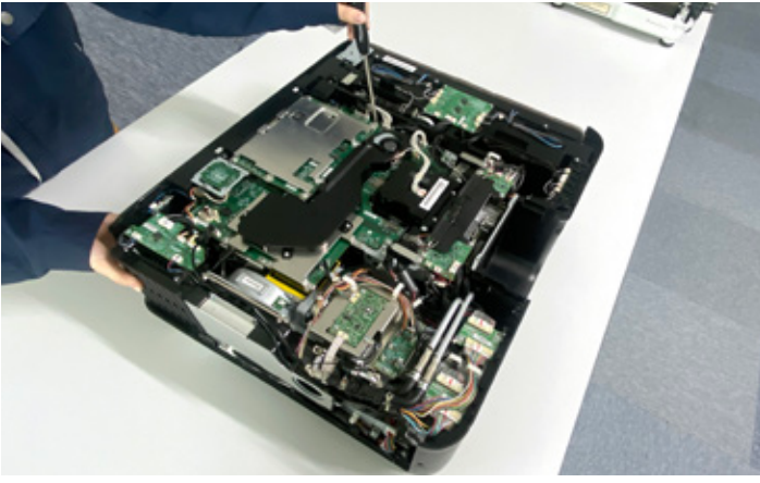
Kolay bakım için modüler bir tasarıma sahip dahili projeksiyon cihazı yapısı
