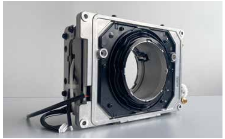
Mecanismo de rotação da lente concebido para evitar a entrada de pó no interior das lentes de projeção
