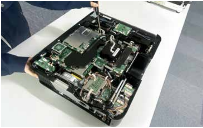
Estructura interna del proyector con un diseño modular para facilitar el mantenimiento
