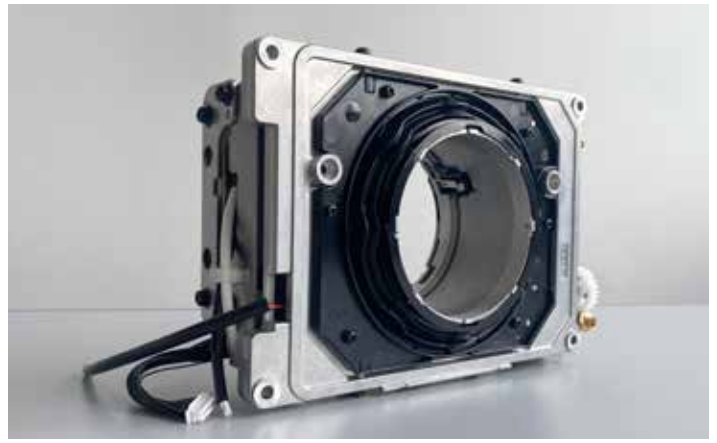
Objektivforskydningsmekanisme, der er designet til at forhindre støv i at trænge ind i projektorobjektiverne
