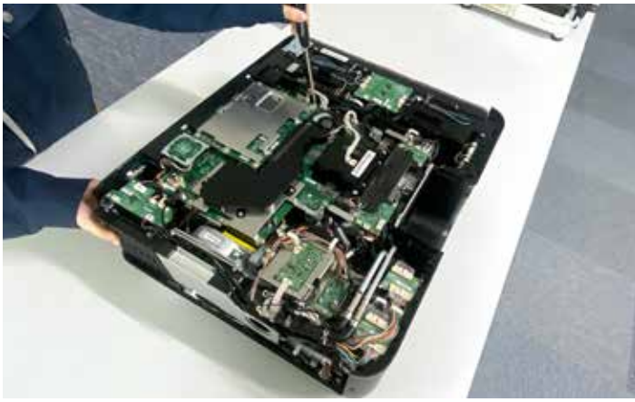
Indvendig projektorstruktur med et modulært design til nem vedligeholdelse
