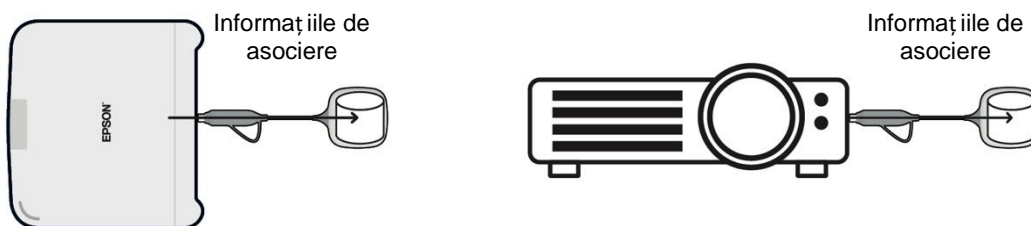
Figura 10. Conectarea și asocierea transmițătorului și receptorului
