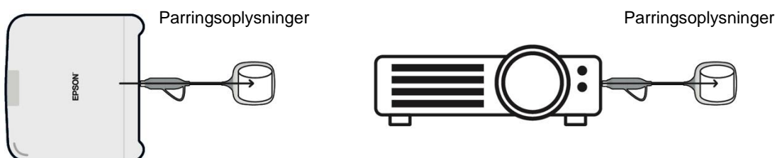
Figur 10. Tilslutning og parring af sender og modtager
