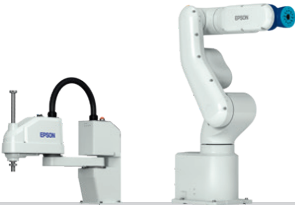
Serie T de SCARA de Epson Carga útil: de 3 a 6 kg Alcance de 400/600 mm
