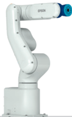
Epson ProSix-VT6L-Serie Traglast: 6 kg Reichweite: 900 mm
