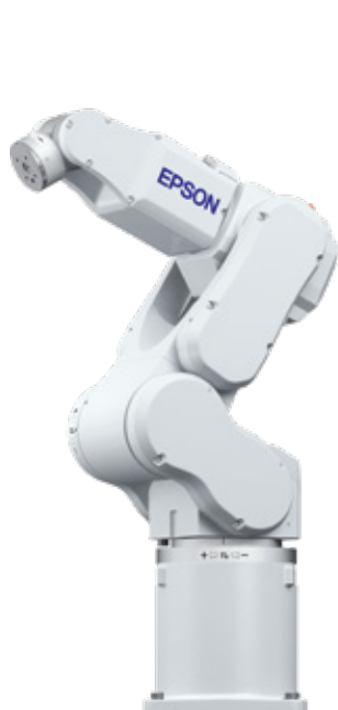
ProSix serii C4 — udźwig 4 kg
