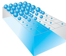
La technologie à taille de gouttes variable Epson offre la combinaison parfaite entre vitesse, qualité et efficacité d'utilisation de l'encre. La meilleure taille de gouttelette d'encre est toujours sélectionnée, qu'il s'agisse de moindres détails ou de surfaces colorées étendues. Il en résulte une image parfaite produite avec une efficacité optimale.
