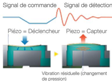
Garantissez une qualité régulière et sans interruption grâce à la technologie de vérification des buses qui détecte les buses obstruées, et la substitution des gouttes pour compenser les buses bouchées. La technologie de vérification des buses permet en permanence d'optimiser la fiabilité et de réduire les temps d'arrêt.
