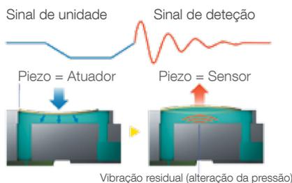
Garanta uma qualidade consistente e permanente com a Tecnologia de verificação dos injetores que deteta os injetores entupidos e os compensa com os pontos necessários. A NVT funciona permanentemente em segundo plano para maximizar a fiabilidade e reduzir o tempo de inatividade.
