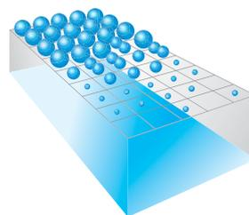
La technologie Epson VSDT offre la combinaison parfaite entre vitesse, qualité et efficacité d'utilisation de l'encre. La meilleure taille de gouttelette d'encre est toujours sélectionnée, de sorte qu'il s'agisse de moindres détails ou de surfaces colorées étendues, il en résulte une image parfaite produite avec une efficacité optimale.
