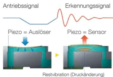
Profitieren Sie mithilfe der automatischen Düsenprüfung von gleichbleibender Druckqualität. Verstopfte Düsen werden sofort erkannt und gereinigt. Die automatische Düsenprüfung sorgt für maximale Zuverlässigkeit und reduziert so die Ausfallzeiten.
