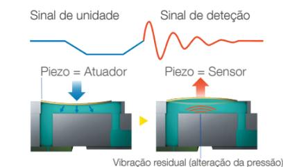
Garanta uma qualidade consistente e permanente com a Tecnologia de verificação dos injetores que deteta os injetores entupidos e os compensa com os pontos necessários. A NVT funciona permanentemente em segundo plano para maximizar a fiabilidade e reduzir o tempo de inatividade.
