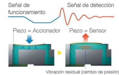
Garantiza una calidad constante y sin interrupciones con la tecnología de verificación de inyectores que detecta bloqueos de inyectores y aplica la compensación de puntos. NVT funciona constantemente entre bastidores para maximizar la fiabilidad y reducir las interrupciones.
