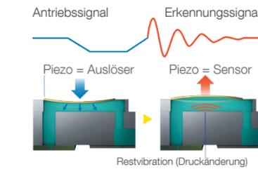
Profitieren Sie mithilfe der automatischen Düsenprüfung von gleichbleibender Druckqualität. Verstopfte Düsen werden sofort erkannt und gereinigt. Die automatische Düsenprüfung sorgt für maximale Zuverlässigkeit und reduziert so die Ausfallzeiten.
