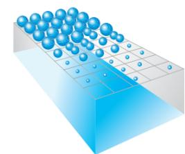
Die Variable Sized Droplet-Technologie von Epson liefert die perfekte Kombination aus Geschwindigkeit, Qualität und effizientem Tintenverbrauch. Es wird stets die optimale Tröpfchengröße gewählt. Dies führt zu einem perfekten Druckbild, das mit bestmöglicher Effizienz erzeugt wird. Dabei spielt es keine Rolle, ob es um feine Details oder große Farbfelder geht.
