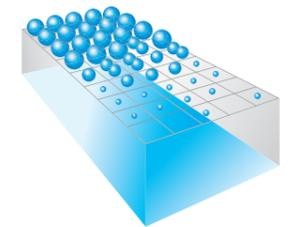
Die Variable Sized Droplet-Technologie von Epson liefert die perfekte Kombination aus Geschwindigkeit, Qualität und effizientem Tintenverbrauch. Es wird stets die optimale Tröpfchengröße gewählt. Dies führt zu einem perfekten Druckbild, das mit bestmöglicher Effizienz erzeugt wird. Dabei spielt es keine Rolle, ob es um feine Details oder große Farbflächen geht.
